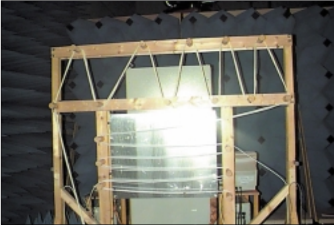
Die geerdete Metallplatte im Kabelaufnahmegestell simuliert Metallträger und -kanäle in den Leitungswegen Quelle: GHMT
